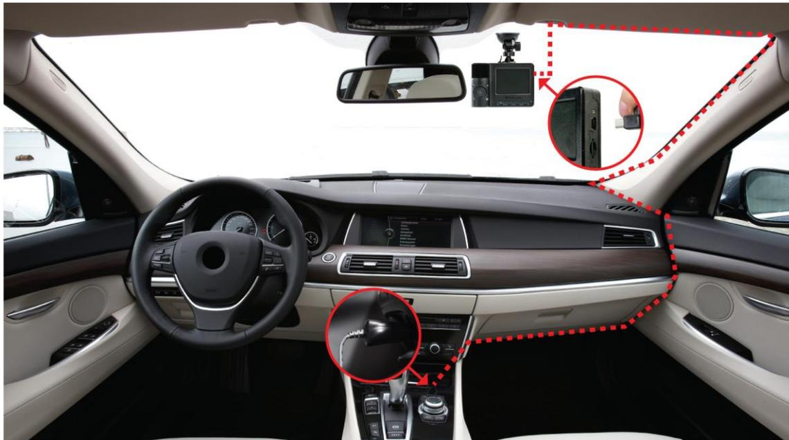
1. Verbinden Sie das kleine Ende des KFZ-Kabels mit dem USB-Anschluss der DrivePro.
