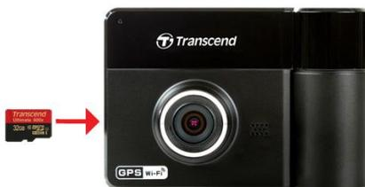
2. Zum Entfernen drücken Sie kurz auf die Speicherkarte, so dass Sie durch einen Federungsmechanismus ausgeworfen wird.
